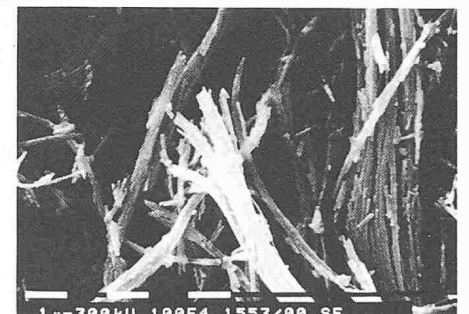
Bild 3. Asbestfasern: Man beachte vor allem die longitudinale Aufspaltung der Fasern in feinste Fibrillen. Vergrößerung 10 000 mal. (Quelle: SUVA)
