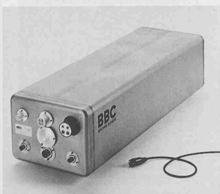
Bild 2. Hochenergiebatterie von BBC (265 kg, 250 dm 3 , 32 kWh, 50 kW)
