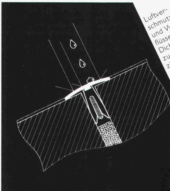
Luftverschmutzung und Witterungseinflüsse setzen elastischen Dichtungsstoffen in Baufugen zu. Das H.A.S.-Abdeck-System reduziert diese Einflüsse drastisch und verlängert die Lebensdauer der Kittfugen auf mindestens das Dreifache. Das H.A.S.-Abdeck-System besteht aus einem Leichtmetall-Hohlprofil mit vormontierten Spezial-Spreizdübeln. Fordern Sie bei einer der untenstehenden Adressen Dokumentation und Muster an.
