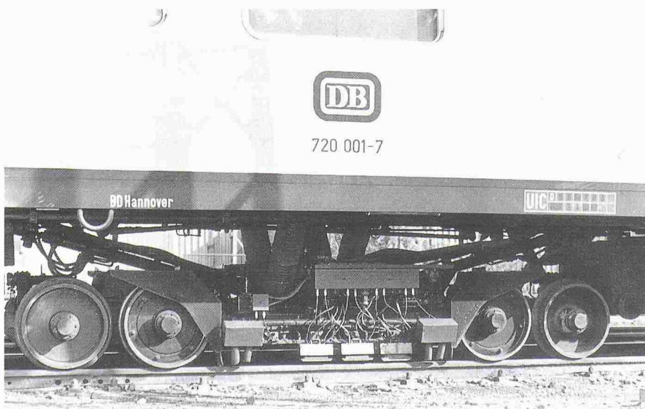
Die dreiteiligen Schienenprüfzüge der Deutschen Bundesbahn orten bei Geschwindigkeiten bis 50 km/h mit Ultraschall mögliche Materialfehler im Stahl der Schiene, die im Lauf der Zeit zu einem Schienenbruch führen können (Bild: db)
