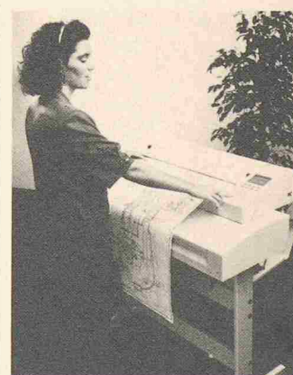
Der «Megafax» übermittelt Formate bis A1
