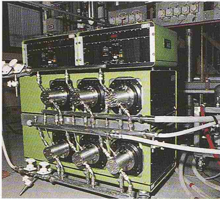
Bild 7. Speziell für die Biotechnologie konstruierte Kolbenpumpen, mit denen steril, volumetrisch und sehr schonend z.B. scherempfindliche Biomasse gefördert werden kann (Bild: Lonza AG, Visp)
