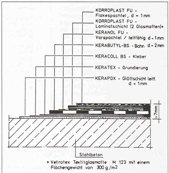
Bild 5. Schichtaufbau des Korroplast-CKW-2000-Abdichtungssystems (Prüfzeichen PAVI 212.043) auf dem Stahlbetonboden eines Auffangraums für organische Lösemittel, Öle, Chlorkohlenwasserstoff (CKW) und andere organische Verbindungen
