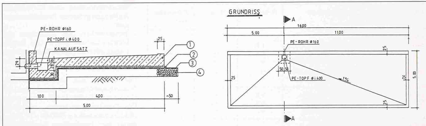
Bild 1. Ab- und Befüllstelle Kelsterbach; Querschnitt der  $5 \times 16$  m grossen Kunststoffaser-Betonplatte mit 25 cm dicker Umrandung (1) auf 5 cm Schutzschicht (Beton B 15, konstruktiv mittig bewehrt mit Q 221) (2), doppelter PE-Folie ( $2 \times 0,2$  mm) (3) und 30 cm kapillarbrechender Schicht, lagenweise verdichtet (4)
