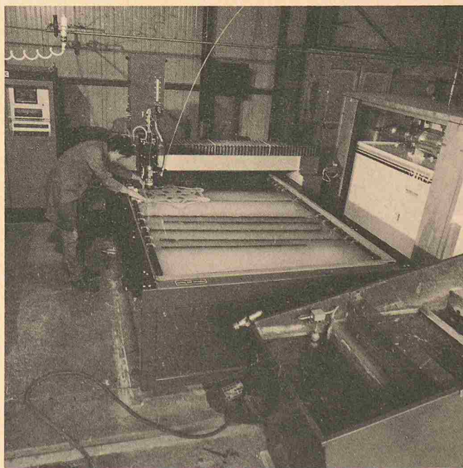
Die komplette Anlage mit Rechner, Hochleistungspumpe, Wasserstrahl-Auffangbecken und Düsensteuerungseinheit
