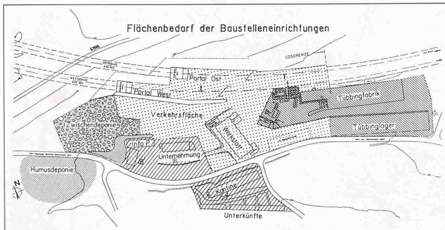
Bild 2. Bözbergtunnel: Installationsplatz Süd
