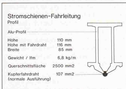
Bild 7. Profil Stromschienen-Fahrleitung
