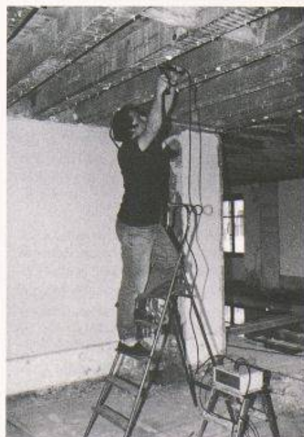
Bild 1. Mit der Ultraschall-Messung kann mit Sicherheit gesagt werden, welches Gewicht die Balkenlast aushalten kann
