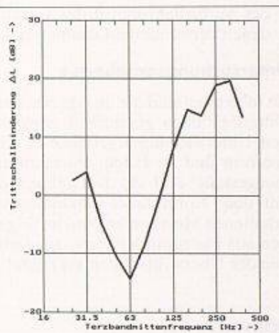
Unterlagsboden-Anordnung 4: Dämmmaterial einlagig aus 1x22 mm dicken Trittschalldämmplatten (elastifizierter Schaumkunststoff)
