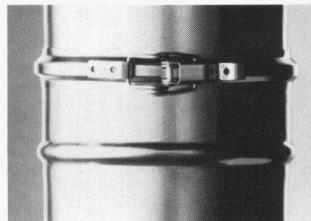
Sicherheit und schnelle Montage mit dem SW-System von SELKIRK. Die Auftulpen erlauben das schnelle, präzise Ineinanderstecken der Elemente. Dann wird das Sicherheitsklemmband über Sicke und Auftulpen gelegt. Einmal schnapp – und fertig!
