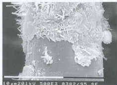
Oben: Verbund aus Zementleim und Glasfasern, rasterelektronenmikroskopische Aufnahme; unten: Zementstein und Calciumminerale haften an den Glasfasern
