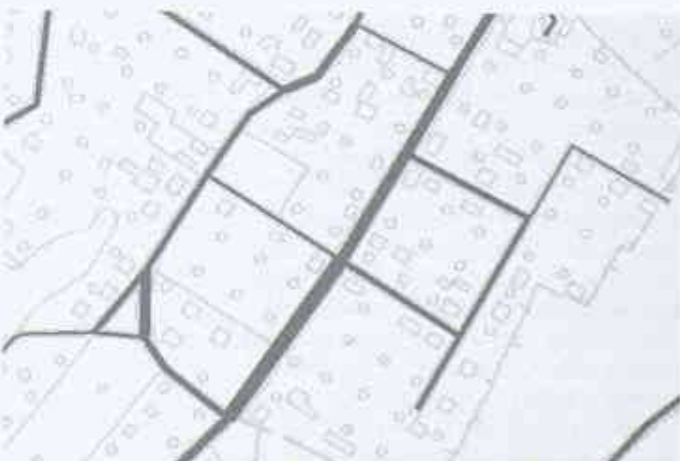
4 Extraktion der Strassenachsen aus Strassenkonturen
