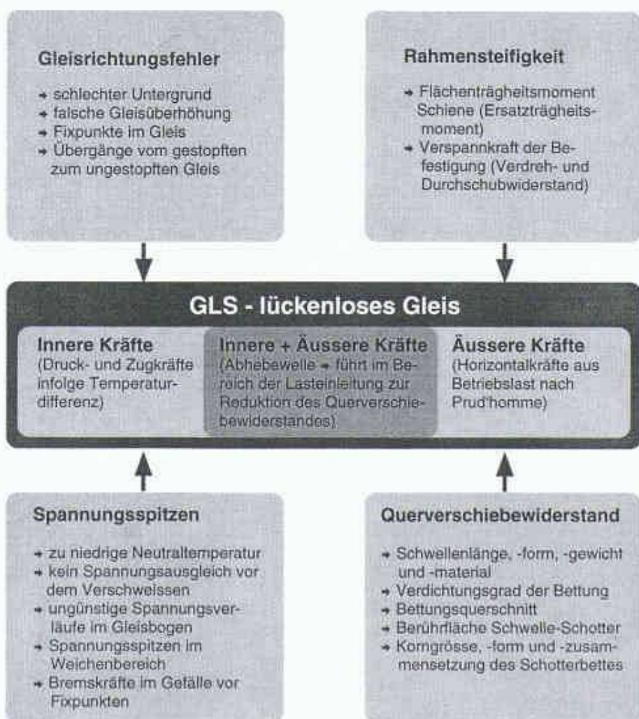
1 Einflussgrössen auf die Gleislagestabilität (= GLS) [3]
