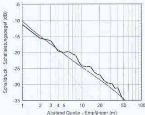
2 Beispiel einer Messung und Berechnung zur Bestimmung von DL2. Die Auswertung der Messung (dickere Kurve) ergibt hier DL2 = 4,0 dB, das berechnete Ergebnis (dünnere Kurve) beträgt DL2 = 4,1 dB. Die dünne, steil abfallende Kurve stellt die theoretische Abnahme des Schalldruckpegels im Freien dar (DL2 = 6 dB).
