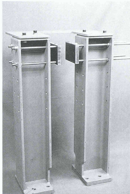
Stützvorrichtung zur Durchführung von Druckversuchen an Stäben
