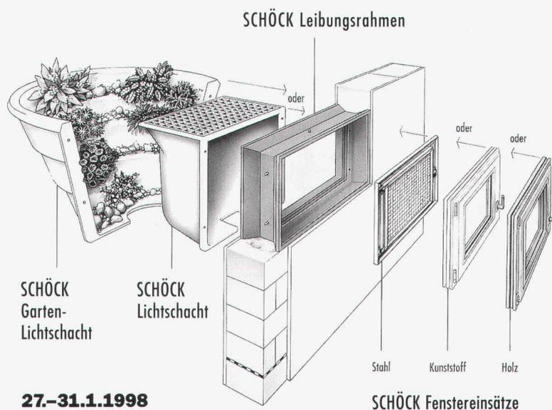
Schöck Lichtschächte aus glasfaserverstärktem Kunststoff sind millionenfach bewährt, enorm stabil, einfach zu montieren und sorgen für mehr Lichteinfall im Kellerraum.
