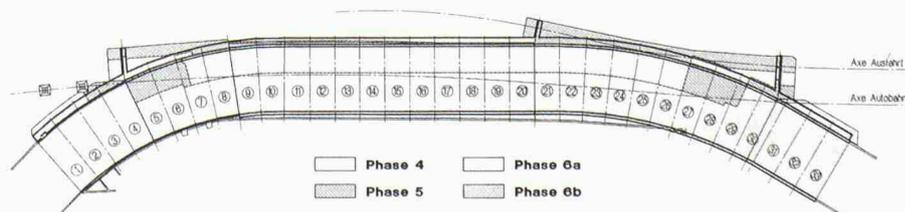
Moglichkeit, die bestehende Fahrbahn so zu verbreitern, dass zweimal zwei Fahrspuren angeordnet werden konnten. Bei Uberleitung von zwei Fahrspuren und der Sperrung der Einfahrt Toss sind etwa zwei Drittel der Flache der Uberdeckung verkehrsfrei, so dass ober- und unterstrom je rund 40 m der Uberdeckung auf der ganzen Breite zuganglich wurden (Bild 10).
