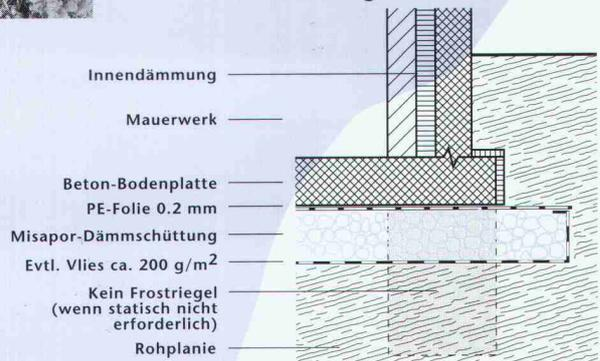
Anstelle eines klassischen Frostriegels kann unter eine Bodenplatte auch einfach Misapor® eingebracht und verdichtet werden. Ein seitlicher Überhang von 30-50 cm Misapor® genügen und schon übernimmt der einfache Schaumglasschotter die Funktion eines aufwendigen Frostriegels. So erspart Ihnen Misapor® Aushub, Armierung, Beton, Frust und vor allem Frost.
