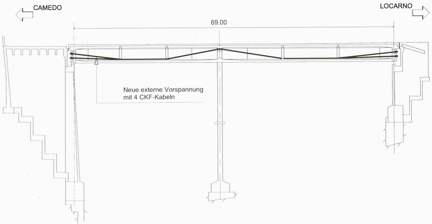
den Vorteilen vor allem hinsichtlich Montage ergeben sich auch in konstruktiver Hinsicht neue Möglichkeiten (kleinere Umlenkvorrichtungen usw.).
