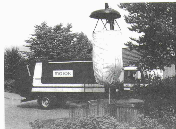
Beim Abfallsammelsystem Molok wird der unterirdisch gesammelte Müll durch einen mit einem Kran herausgezogenen Sack entleert
