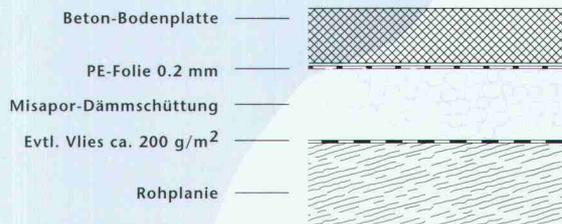
Aushub raus, Misapor® rein, PE-Folie drüber, Haus drauf! Im Detail: Mit Lastwagen, Big Bags oder Kran Misapor® direkt auf die Rohplanie entleeren. Nichts anpassen, nichts zuschneiden. Mit einer Walze oder einem Plattenvibrator Misapor® um Faktor 1.3 verdichten. Eine abschliessende PE-Folie verhindert das Eindringen der Zementmilch - und schon kann weitergebaut werden. Einfachere Verarbeitung = kürzere Bauzeit = kleinere Kosten. So einfach ist das.
