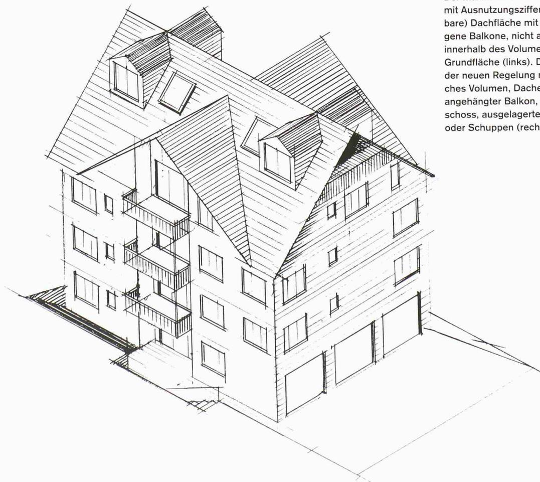
Der maximierte Bau nach der alten Berechnung mit Ausnutzungsziffer: grosse (nicht anrechenbare) Dachfläche mit vielen Aufbauten, eingezogene Balkone, nicht anrechenbare Nebenräume innerhalb des Volumens zur Erhöhung der Grundfläche (links). Der maximierte Bau nach der neuen Regelung mit Baumassenziffer: einfaches Volumen, Dacheinschnitte statt Aufbauten, angehängter Balkon, abgegrabenes Tiefgeschoss, ausgelagerte Nebenräume wie Garagen oder Schuppen (rechts). [Bilder: Valeri Heim]
