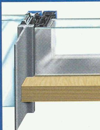
GFK bildet das Basismaterial für den Flügel- und Blendrahmen. Dieser im Fensterbau neuartige Werkstoff verbindet in idealer Weise Stabilität, Wärmedämmung und Langlebigkeit bei niedrigem spezifischen Gewicht.
