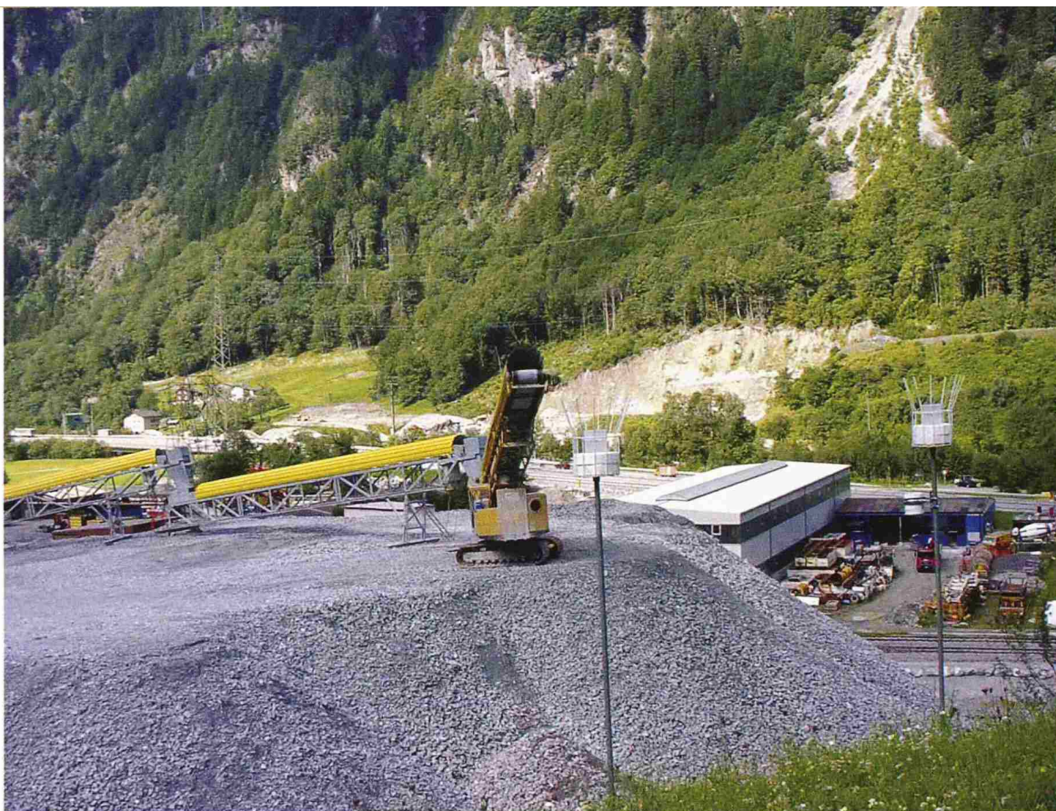
Abgedeckte Förderbänder und Übergabestationen vermindern die Staubbelastung (Bild: Ch. Leuenberger)
