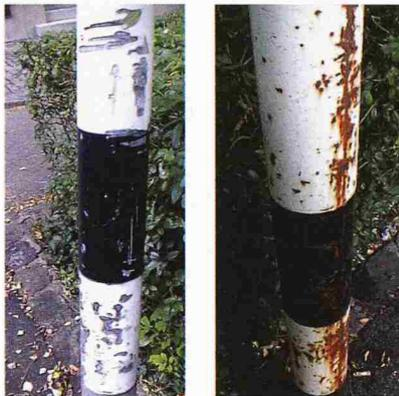
Links: Der feuerverzinkte Strassenpfosten weist dank hoher mechanischer Beständigkeit und kathodischem Schutz trotz Beschädigungen keine Rostbildung auf. Rechts: Der lackierte Strassenpfosten bildet nach Beschädigungen Rost
