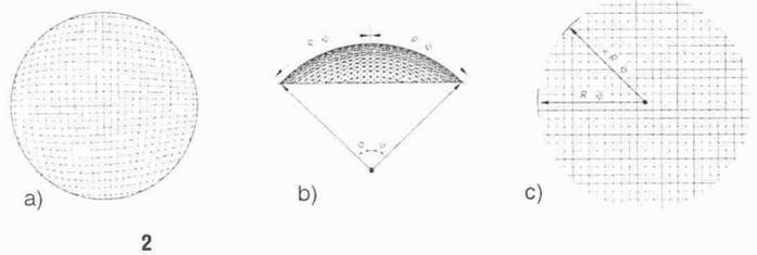
2 Geometrieprinzip Netzcupkuppeln: a) Draufsicht ohne Seildiagonale, b) Ansicht mit Seildiagonale, c) abgewickelltes Seilnetz (= ebenes Quadratnetz)
