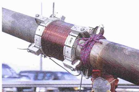
verschoben und mit Sensoren kontinuierlich das erzeugte Magnetfeld gemessen wird, so lässt sich feststellen, wo überall Fehlstellen im Inneren des Seils vorhanden sind. Ein Feldversuch in Bangkok verlief viel versprechend. Zurzeit befindet sich die Messausrüstung in einer Optimierungsphase. Die Rechte zur Nutzung der Empa-Entwicklung werden interessierten Branchen in Lizenzverträgen übertragen.
