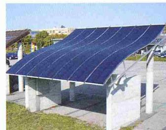
gesetzt werden. Die Solarmodule eignen sich für Dachkonstruktionen aus Holz, Metall oder Beton und bilden eine dichte Dachhaut. Die Halterungen der Solar-Freestyle-Elemente sind kompatibel mit solarthermischen Elementen, was eine einfache Kombination beider Technologien ermöglicht. Der gewonnene Strom kann wahlweise gegen Vergütung jeder Kilowattstunde in ein Stromnetz eingespeist werden oder Teile des hauseigenen Verbrauchs decken.
