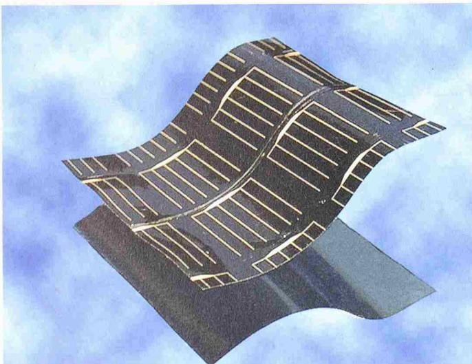
**Die an der ETH Zürich entwickelte Dünnschicht-Solarzelle. Sie zeichnet sich durch Biegsamkeit und einen sehr hohen Wirkungsgrad aus – ideale Voraussetzungen, den Markt zu erobern (Bild: Dünnschichtphysikgruppe ETH Zürich)**
