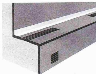
ven Bauteilen breitflächig als Luftschall abgestrahlt, was in Treppenhäusern von Wohn- und Geschäftsbauten oft zu unliebsamen Immissionen führt. Neu im Programm ist das Lasto-Trela-Treppenlager. Es eignet sich als wirksame, trittschalldämmende Auflage. Mit dem verwendeten Trapezkern wird bei einer Erregung von 100 Hz eine Isolierwirkung von über 90 % bzw. ein Trittschallverbesserungsmass von mehr als 20 dB erreicht.
