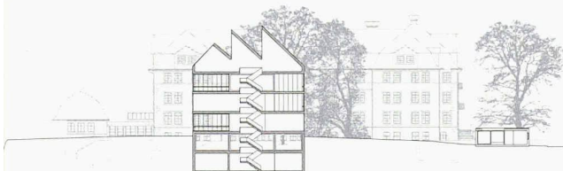
Querschnitt durch das Schulhaus mit dem aufgefächerten Sheddach (1. Rang, e2a eckert eckert architekten)
