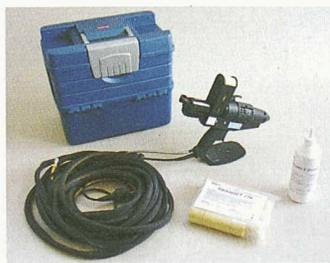
le wird der Kleber reaktiviert und zum Verbund gebracht. Im Arbeitsablauf ergibt sich eine grosse Flexibilität. Die umfassende Felderprobung hat zur Gestaltung des sicheren Verfahrens beigetragen. Verschiedenste Untergründe wie Beton, Backstein, Holz, Wärmedämmstoffe haben sich als geeignet erwiesen. Blechuntergründe werden entfettet. Mit Vorteil wird der entsprechende lösemittelfreie Sarnafil Primer T 770 eingesetzt. Sarnafil AG | 6060 Sarnen
