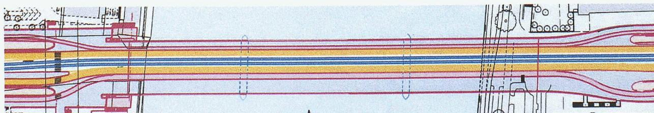
Die weitgehend identischen Zwillingbrücken wirken als Durchlaufträger über drei Felder mit Spannweiten von 77,105 und 84 m. Die Fahrbahnplatten sind durch ein vertikales Strebenfachwerk mit ausbetonierten Stahlhohlkästen von  $40 \times 40$  cm als sichtbare Diagonalen verbunden. Quer vorgespannte Rippenplatten mit einer Spannweite von ca. 15 m zwischen längs vorgespannten Betongurten tragen die Fahrbahnen. Die Gesamtbreite misst 33 m, und die konstante Bauhöhe
