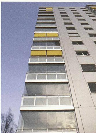
geöffnet werden. Feine Luftschlitze zwischen den einzelnen Glaselementen lassen die Balkone natürlich atmen und verhindern so Feuchtigkeitsschäden. Die Sio AG, Generalvertretung Cover, ist an der Fachmesse Bauen und Modernisieren, Halle 2, Stand B 17, vertreten.
