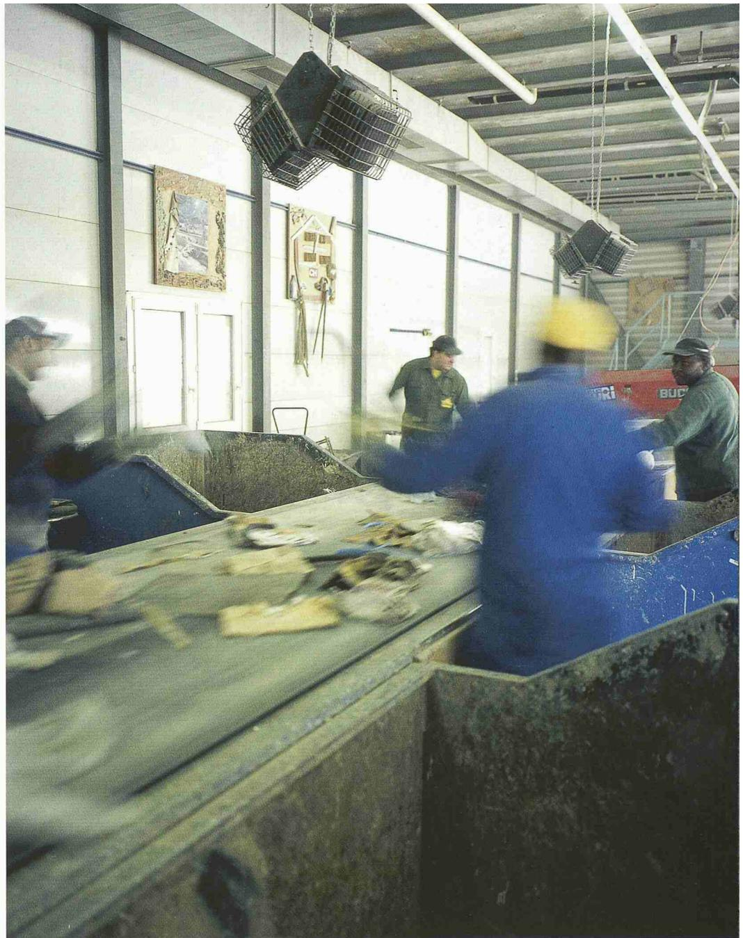
Eine riesige Siebtrommel (unten rechts) trennt Bauschutt nach der Grösse: Was kleiner als 40 mm ist, gelangt in ein Rüttelsieb (unten links), was 40-200 mm gross ist, kommt in den Magnetabscheider. Der Bauschutt, der die Siebtrommel verlässt, zieht auf der Handlesestrecke an Arbeitern vorbei (oben). Diese trennen Holz, Metall und Gips vom übrig gebliebenen Bauschutt. Dieses Material wird später rezykliert. Brennbares gelangt in die KVA, Mischabbruch bleibt auf dem Förderband
