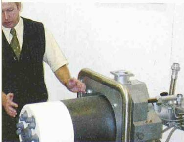
Ein Prototyp eines neu entwickelten Brenners für Biobrennstoffe (Bild: Ökozentrum Langenbruck)
