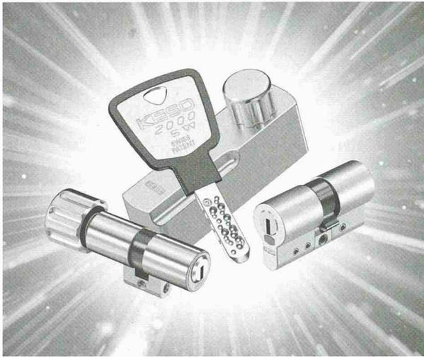
Ein Schlüssel des KEKgenie-Systems funktioniert wie ein normaler Schlüssel: voll mechanisch und kompatibel auch für bestehende KESO-Schliessanlagen. Aber er hat ein Geheimnis – den integrierten elektronischen Chip. Der macht den Schlüssel individuell programmierbar. Steckt man ihn in einen Schliesszylinder, registriert die Elektronik die Identität des Schlüssels und schaltet ihn frei – oder auch nicht.
