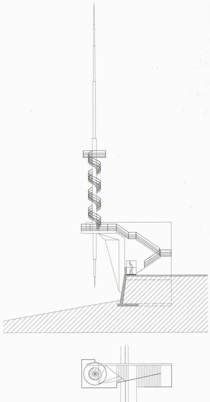
Der Turm für Telekommunikationseinrichtungen wird im unteren Teil durch einen Betonsockel gehalten. Der Durchmesser des Stahlrohres beträgt dort 812 mm, die Blechdicke 20 mm. Nach oben und nach unten nehmen die Dimensionen ab, das Gewicht der Antenne beträgt 15 t (1. Preis, Bacciarini, Maggini, Selmoni)
