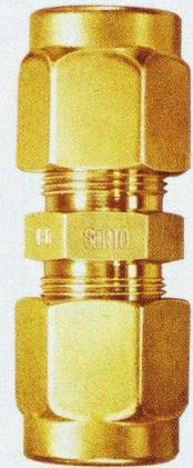
Die Schweizer Serto AG fertigt jetzt auf Wunsch alle Rohrverbindungen des Sortiments aus bleifreiem Messing. Das entspricht den weltweit schärfsten Anforderungen nach sicheren Rohrverbindungen ohne Blei. Blei ist für den Menschen hochgiftig. Serto unterschreitet den in der deutschen Norm DIN 50930-6 geforderten maximalen Bleigehalt von 2 % in den Messing-M- und Messing-G-Legierungen.
