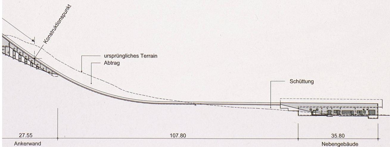
führt worden. Während der Schütтарbeiten sind im unteren, flachen Bereich Kriechbewegungen aufgetreten. Die Schütтарbeiten mussten deshalb verlangsamt werden, damit sich der zusätzliche Porenwasserdruck abbauen konnte.
