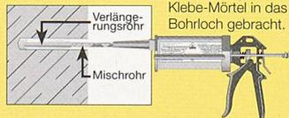
Der Bewehrungsstab wird in die Bohrung geführt und in die Klebe-Mörtel-Masse gedrückt.
