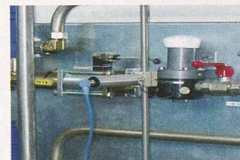
und Abfüllanlagen. Gemessen wird berührungslos mittels Ultraschall durch die Rohrwand hindurch, so dass keine baulichen Veränderungen am Rohr notwendig sind, unabhängig davon, ob die Rohrleitung aus metallischen Werkstoffen, Kunststoffen oder aus Glas besteht. Je höher die Druckstufe oder die Reinheitsanforderungen, desto mehr kann der Sonocontrol 15 seine spezifischen Vorteile einbringen.
