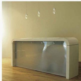
Der Empfangstresen von «Beton Ware» ist aus massivem Leichtbeton gefertigt. Die Formteile sind durch eingegossene Stahlträger stabil, die Montageplatten sind als Bausatz montierbar. Das gezeigte Objekt misst 240×95×50 cm, die Front ist mit Acrylglas verkleidet. Beton Ware stellt auch Sitz- und Regalwürfel aus faserverstärktem Beton her. Diese haben eine Kantenlänge von 39 cm und können beliebig eingefärbt werden, ihre Wände sind zirka 15 mm stark. Beton Ware | D-10967 Berlin www.betonware.de
