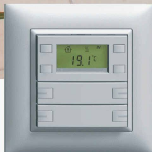
EIB/KNX-Taster mit Raumthermostat
