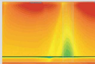
Im Beispiel links wurde die Raumluftströmung so optimiert, dass auf der Fassade garantiert zu keinem Zeitpunkt Kondensation auftritt. Die Berechnung der Luftströmung und der Temperaturen erfolgte mit einer CFD-Simulation.
