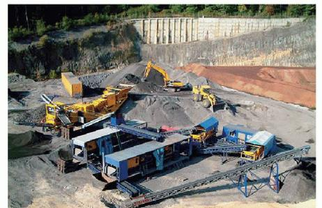
Backenbrecher aus dem Bergbau zertrümmern die mineralischen Schlackebrocken. Die weniger als 2 mm grossen Krümel werden abgeseibt, zurück bleiben die grösseren, lediglich verformten Metallstücke (Bild: Bau- und Umweltschutzdirektion Basel-Landschaft)
