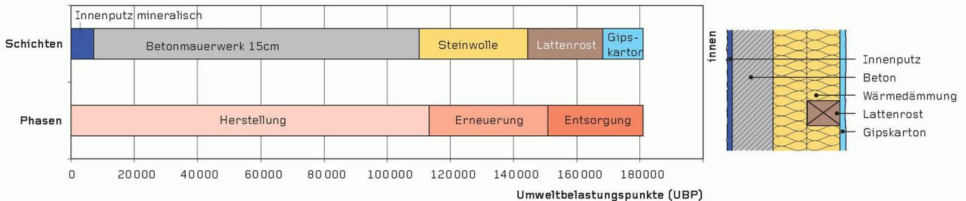
Die Umweltbelastung einer Aussenwand, über die gesamte Lebensdauer von 100 Jahren gerechnet, in Umweltbelastungspunkten (UBP) pro m<sup>2</sup> Bauteilfläche (Grafiken: [www.bauteilkatalog.ch](http://www.bauteilkatalog.ch))
